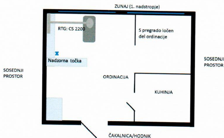
Slika 2: Shematski tloris namestitve RTG aparata v zobni ambulanti.
