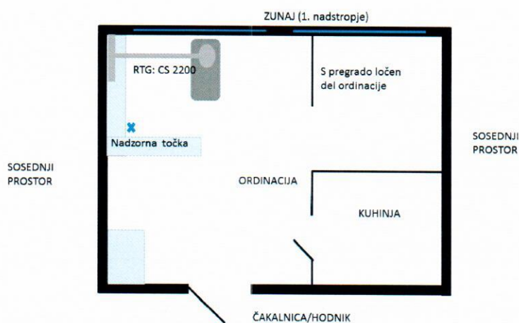
Slika 2: Shematski tloris namestitve RTG aparata v zobni ambulanti.
